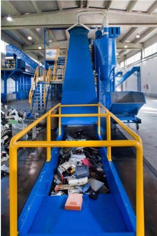
Stavljanje EE otpada u postrojenje za oporabu
