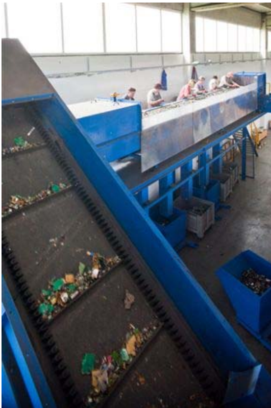
Usitnjeni EE otpad na traci nakon prolaska kroz prvi usitnjivač i magnetni separator
