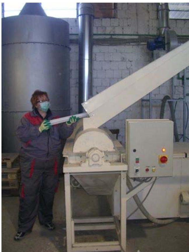
Stroj s filterom aktivnog ugljena za odvajanje žive iz fluo žarulja
