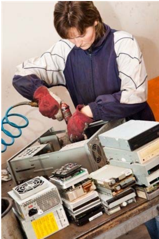
Izdvajanje vrijednih komponenti iz računala
